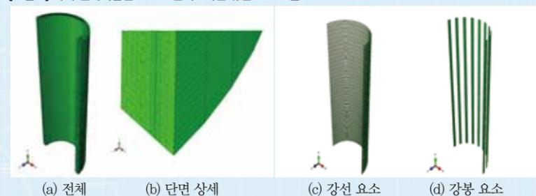
부가 없이 구조물은 평형상태가 된다. 이러한 평형상태화를 통해 강선과 강봉에 가해진 인장응력은 강봉과 강선이 포함된 콘크리트와 모르타르에 압축응력을 부가시키도록 해석용 유한요소 모델을 구성할 수 있다. 강선에 비하여 상대적으로 크기가 큰 강봉도 Rebar 옵션을 이용하여 모델링한 경우의 해석모델은 파손 해석상 강선의 파손이 강봉의 파손보다 지배적이기 때문에 강봉에 대해 상세 모델링을 수행하지 않아도 되는 장점이 있다. 또한, 강선의 경우 그 크기가 작고 촘촘하게 배치되어 상세 모델링을 수행하면 너무 많은 유한요소가 필요하고 해를 수렴하는데 있어서 오류가 발생 가능함에 따라 강선과 강봉 모두를 Rebar 옵션을 수행하여 모델링하고 해석결과를 도출하는 것이 타당한 것으로 분석되었다.
